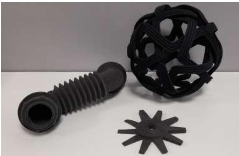
Ilustración 23. Piezas demo en tecnologías de fabricación aditiva, en concreto Multi Jet Fusion de HP
