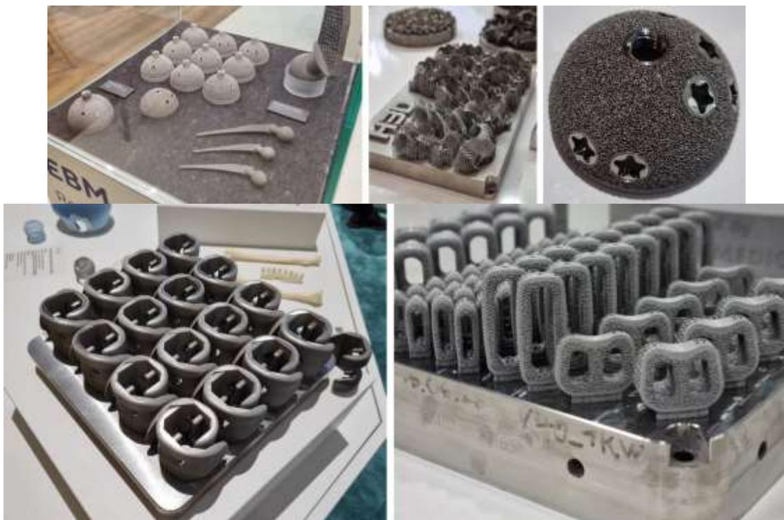
Ilustración 12. Implantes y dispositivos médicos producidos en tecnologías de fabricación aditiva para el procesamiento de metales.
