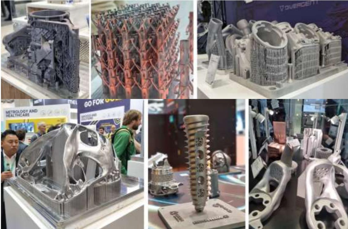
Ilustración 10. Piezas metálicas producidas en tecnologías de lecho de polvo basadas en láser PBF-LB/M
