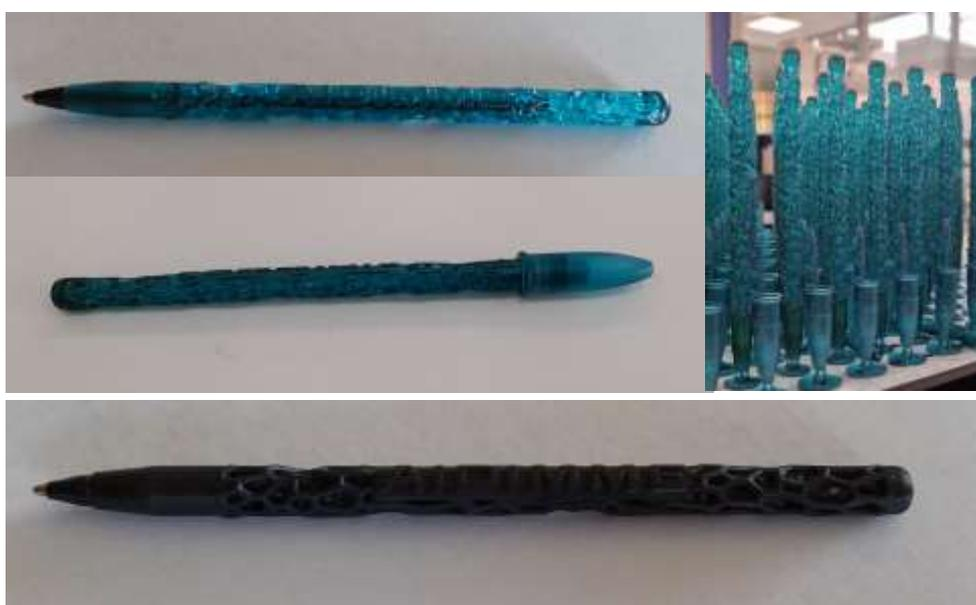
Ilustración 17. Bolígrafo demo fabricado con tecnología de resina con la tecnología LCD en distintos materiales
