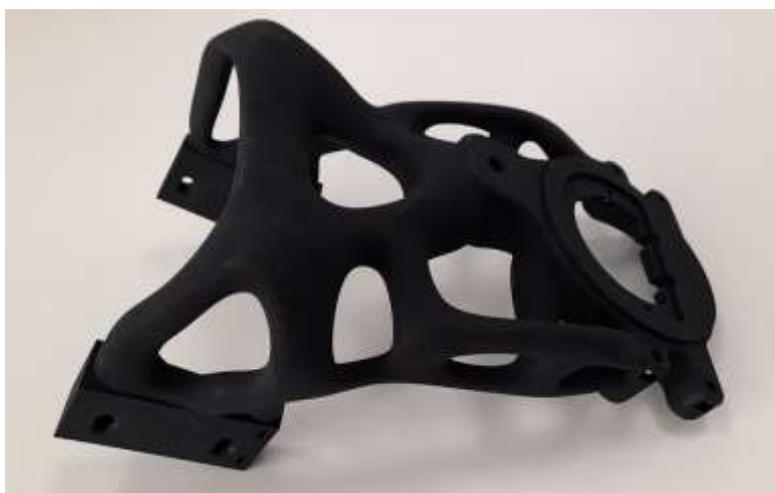
Ilustración 24. Piezas demo en tecnologías de fabricación aditiva, en concreto Multi Jet Fusion de HP
