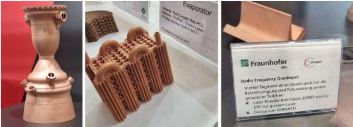
Ilustración 13. Piezas producidas en cobre puro en tecnologías aditivas basadas en laser (PBF-LB/M)
