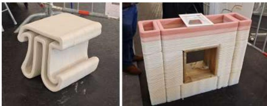
Ilustración 7. Piezas producidas en hormigón mediante fabricación aditiva.
